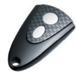
Håndsender Micro-Novotron 512 Design 2-kanal, 433 MHz, KeeLoq skiftekode
