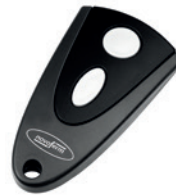
Håndsender Mini-Novotron 502 2-kanal, 433 MHz, KeeLoq skiftekode
