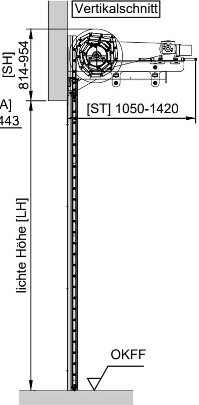
Vertikalschnitt - Deckenmontage
